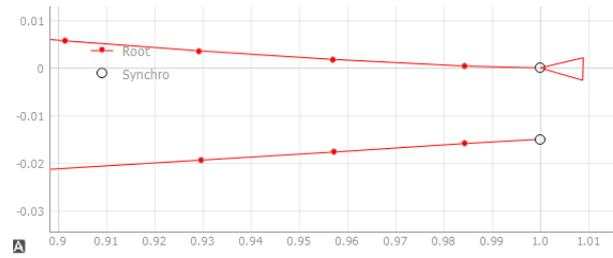
Ajouter un emplacement pour un renfort balsa 29x2 mm (fonctions utilisées : sélectionner des points, insérer en extrapolation linéaire entre la sélection et faire glisser la sélection) :
