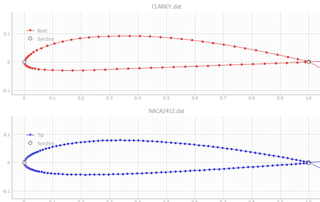
Pour les profils standards (par exemple section d'aile), ces points sont généralement suffisants.
