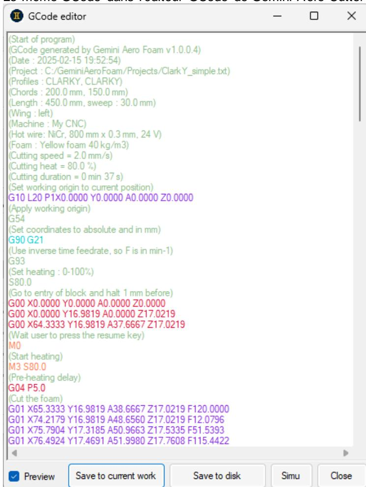
Notez la pause M0 après que le fil se soit positionné 1 mm avant la mousse à découper. Cela permet de finaliser, si besoin, le positionnement du bloc avant la découpe. Une fois la pause terminée (= l'utilisateur appuie sur le bouton « Reprendre »), le fil chauffe d'abord, puis découpe la mousse.
