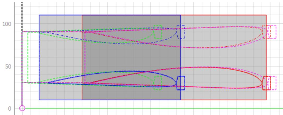
Cette fonction permet de couper simultanément les ailes gauche et droite d'un avion.
