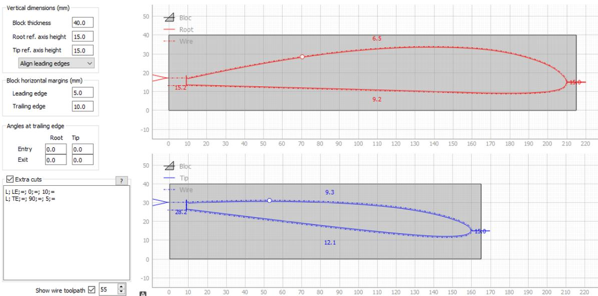
Les dimensions du bloc de mousse et la position des profils dans le bloc sont définies ici. La trajectoire du fil est affichée (avec le décalage de la saignée calculé avec la configuration de la mousse).
