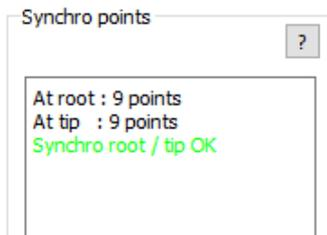
**Les points de synchronisation sont fondamentaux pour obtenir un bon résultat**, car la longueur des portions synchronisées peut être alternativement supérieure ou inférieure sur le profil d'emplanture et de saumon, de sorte que la largeur de saignée doit être recalculée pour chaque portion et côté en fonction de la vitesse de coupe locale.
